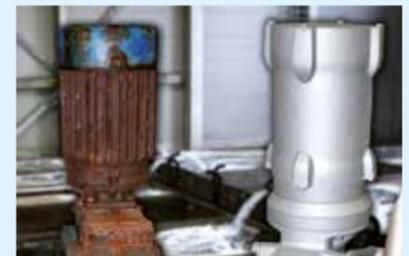
Dans l'image à droite : Motoréducteur avec un traitement de surface nsd tupH après 12 mois de fonctionnement
