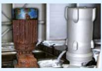
A destra in figura: motoriduttore con trattamento superficiale nsd tupH dopo 12 mesi di servizio
