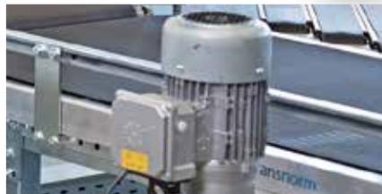
Des moteurs performants jusqu'à IE4 maintiennent en mouvement les systèmes d'entraînement dans toutes les situations.
