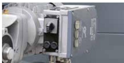
Les commutateurs et boutons sont directement disposés sur les entraînements et permettent le démarrage direct, l'arrêt ainsi que les modifications de mode.
