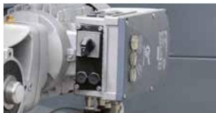
Interruttori e pulsanti vengono disposti direttamente sugli azionamenti e permettono un avvio diretto, arresto e cambio della modalità.
