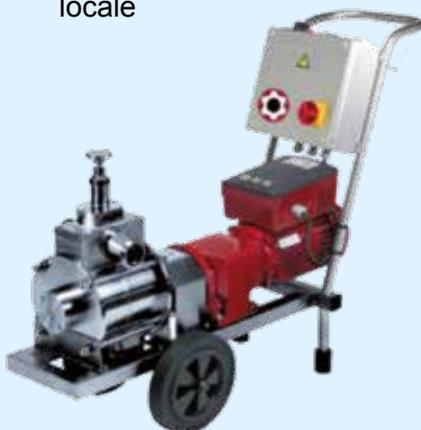
Pompe à vin mobile avec variateur de fréquence SK 200E
