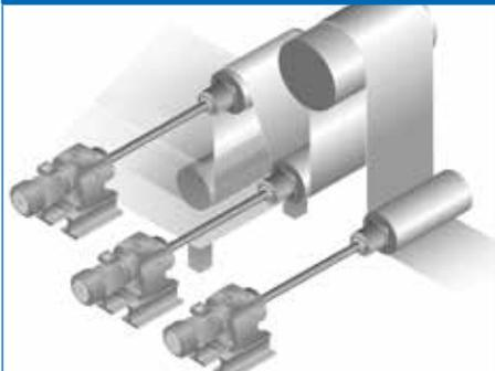
Viele Getriebemotoren werden in Prozesslinien beispielsweise zur Vergütung, Beschichtung und Galvanisierung eingesetzt und trotzen den dort vorherrschenden aggressiven Bedingungen.
