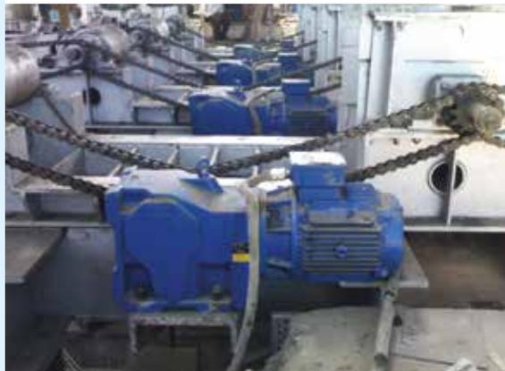
Kegelradgetriebemotoren für Kühlbett – Kettenzuführtische
