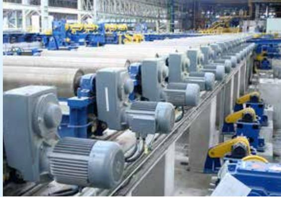
Flachgetriebemotoren für Rollengänge
