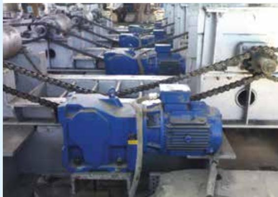
Réducteurs à couples coniques pour tables transfert à chaîne du poste de refroidissement
