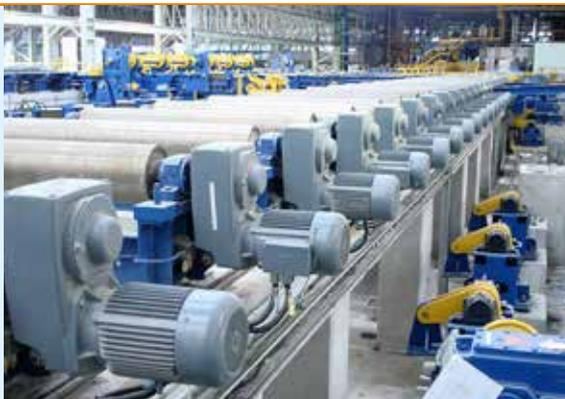
Мотор-редукторы с параллельными валами для прокатных станов
