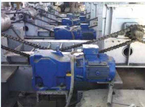
Двигатели с коническим редуктором для цепных подающих столов в холодильниках прокатных станов
