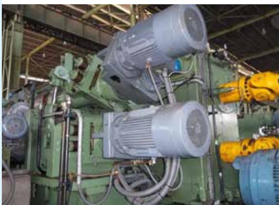
Прижимные ролики для линий горячей прокатки
