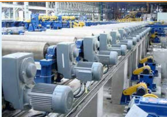
Motoriduttori ad assi paralleli per vie a rulli
