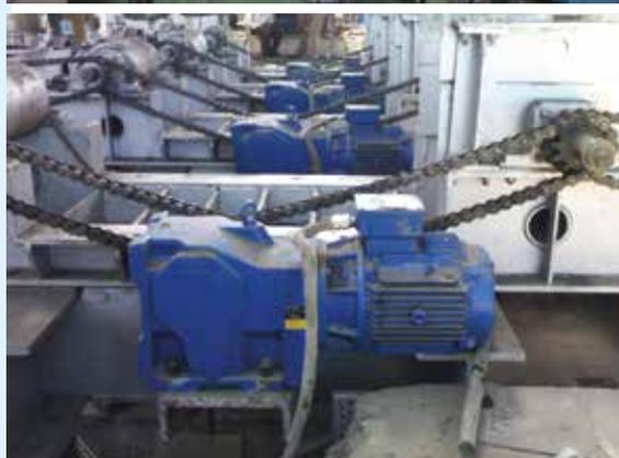
Motorreductores de engranaje cónico para lechos de enfriamiento – mesas de alimentación mediante cadenas
