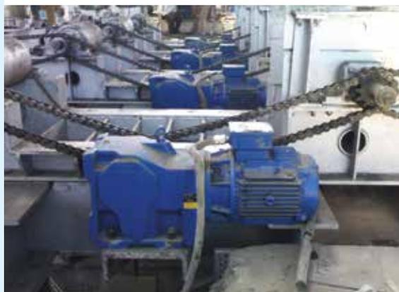
Motoredutores de engrenagens cônicas para mesas de alimentação em leitos de resfriamento
