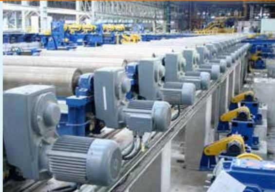
Motoredutores de eixos paralelos para transportadores de rolos
