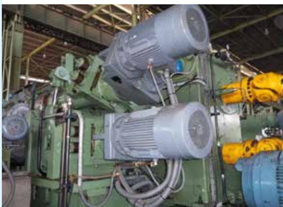
Прижимные ролики для линий горячей прокатки
