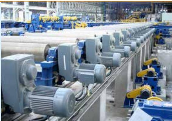
Мотор-редукторы с параллельными валами для прокатных станов
