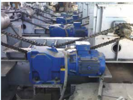
Motoreduktory walcowo-stożkowe do chłodni – stoły podawcze łańcuchowe
