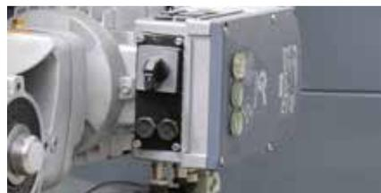
Schalter und Taster sind unmittelbar an den Antrieben angeordnet und erlauben den direkten Start, Stopp sowie Modusänderungen.
