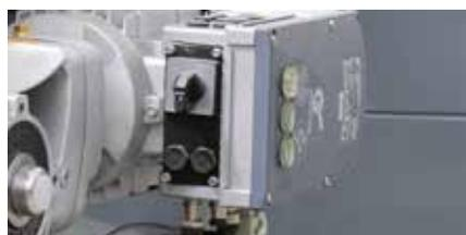
スイッチおよびボタン類は直接駆動装置に配置されており、ダイレクトなスタート、ストップならびにモード変更が可能です。
