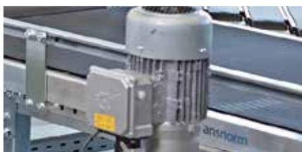
最大IE4の高性能モーターが、どのような運転状況でも駆動システムを動かし続けます。
