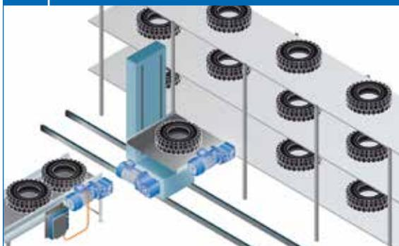
Au sein de l'usine, les pneus sont acheminés sur des transporteurs à bande ou à rouleaux. L'installation inclut des ascenseurs, des transporteurs inclinés, des aiguilles et des transporteurs suspendus.
