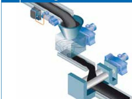
Le processus de fabrication d'un pneu débute avec le mélange des composants. Ils sont mélangés à hautes températures et pressions dans des mélangeurs, afin d'obtenir une masse homogène.
