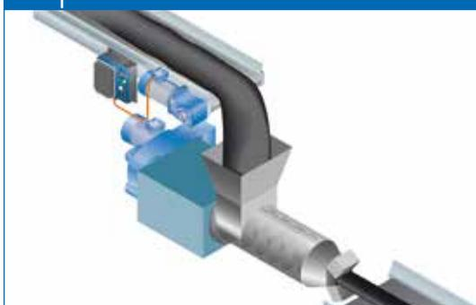
Une extrudeuse se compose d'un cylindre et d'une vis d'extrusion. Les composants en caoutchouc sont mélangés à haute pression dans l'extrudeuse, puis pressés via une buse.
