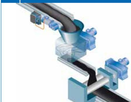
Il processo di produzione di uno pneumatico inizia con la miscelazione dei componenti. La miscelazione a valori di temperatura e di pressione altissimi consente di ottenere una massa omogenea.
