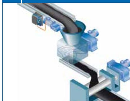
El proceso de fabricación de neumáticos se inicia con la mezcla de los componentes. Estos se mezclan en mezcladoras a altísimas temperaturas y presiones para obtener una masa homogénea.
