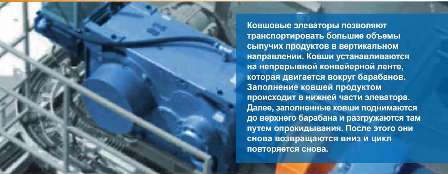
Ковшевые элеваторы позволяют транспортировать большие объемы сыпучих продуктов в вертикальном направлении. Ковши устанавливаются на непрерывной конвейерной ленте, которая движется вокруг барабанов. Заполнение ковшей продуктом происходит в нижней части элеватора. Далее, заполненные ковши поднимаются до верхнего барабана и разгружаются там путем опрокидывания. После этого они снова возвращаются вниз и цикл повторяется снова.
