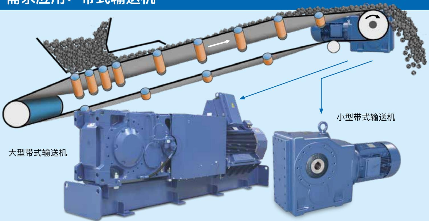
带式输送机用于连续作业的散装物料运输。主要由托辊及在其上运行的输送带组成。输送带既用作承载工具也提供输送功能。能够实现长距离大批量的经济运输。其长度从几米到几千米不等。输送带可以水平运
