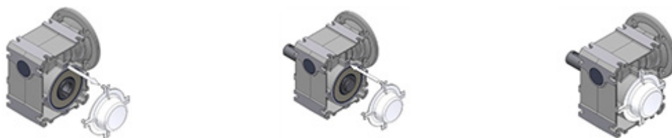
Фигура 18: Демонтаж и монтаж на предпазния капак
