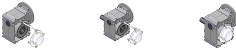
Obr. 18: Demontáž a montáž hřídelového krytu
