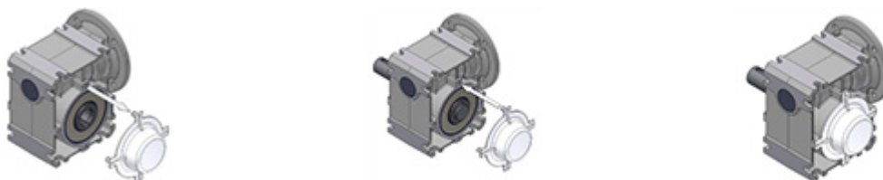
Illustration 18: Afmontering og montering af afdækningshætter
