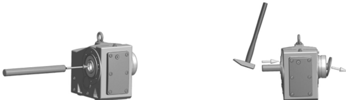
Illustration 8: Afmontering af den fabriksmonterede blindprop
