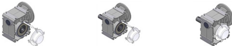
Abbildung 18: Demontage und Montage der Abdeckkappe
