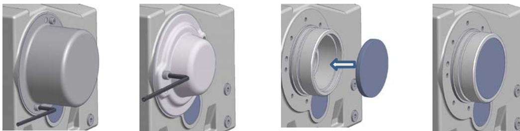
Abbildung 17: Montage der Abdeckhaube Option SH, Option H und Option H66
