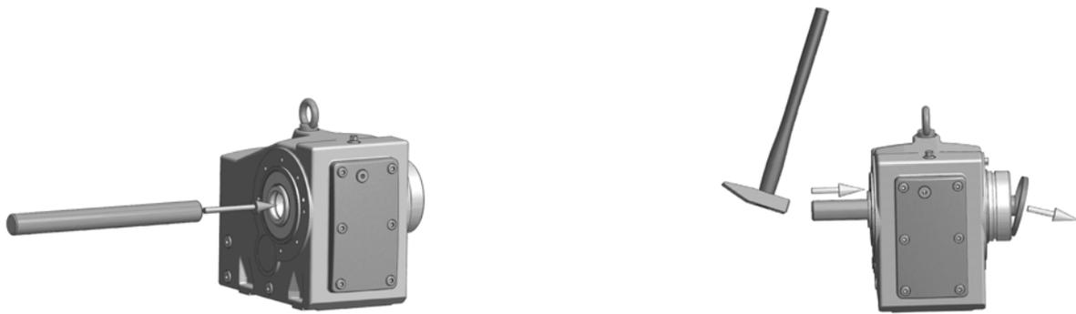
Abbildung 8: Demontage der werkseitig montierten Verschlusskappe
