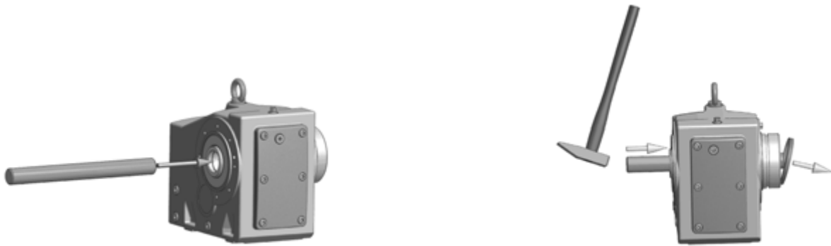
Εικόνα 8: Αποσυναρμολόγηση του καλύμματος ασφάλισης που έχει τοποθετηθεί από το εργοστάσιο
