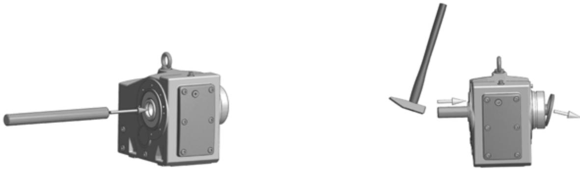
**Figura 8: Desmontaje de la caperuza de cierre montada de fábrica**
