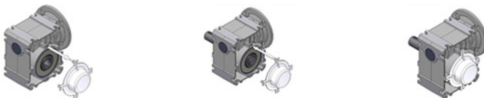
Figura 18: Desmontaje y montaje de la caperuza de protección
