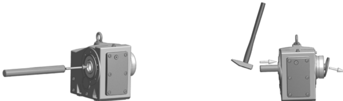
Joonis 8: Tehases paigaldatud sulgurkorgi eemaldamine
