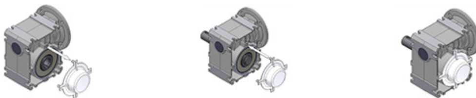
Joonis 18: Kaitsekate eemaldamine ja paigaldamine
