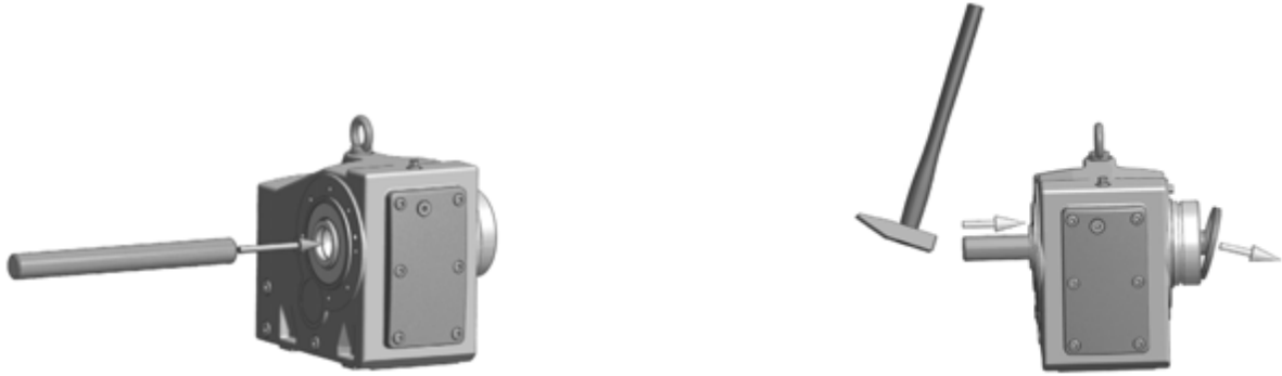
Kuva 8: Tehtaalla asennetun sulkutulpan irrottaminen
