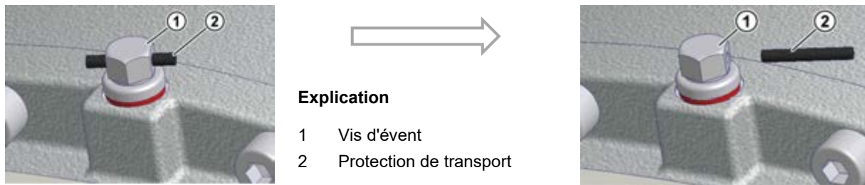
Figure 2 : Activation de la vis d'évent
