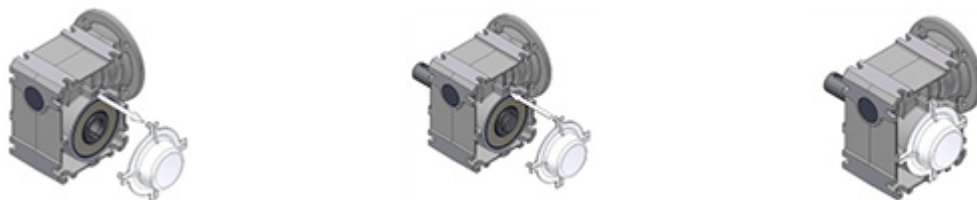
Slika 18: Demontaža i montaža pokrovne kape
