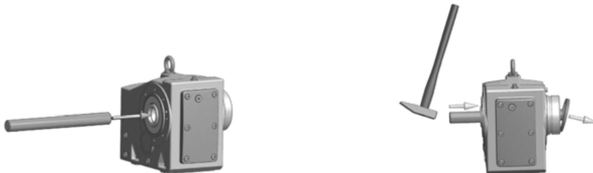
8. ábra: A gyárilag felszerelt zárófedél leszerelése
