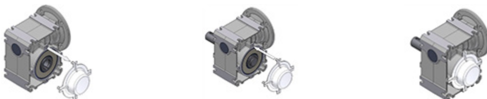
18. ábra: A zárókupak le- és felszerelése
