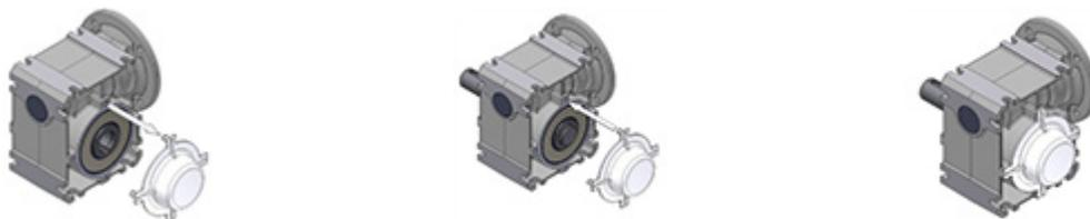
Figura 18: smontaggio e montaggio del coperchio di protezione
