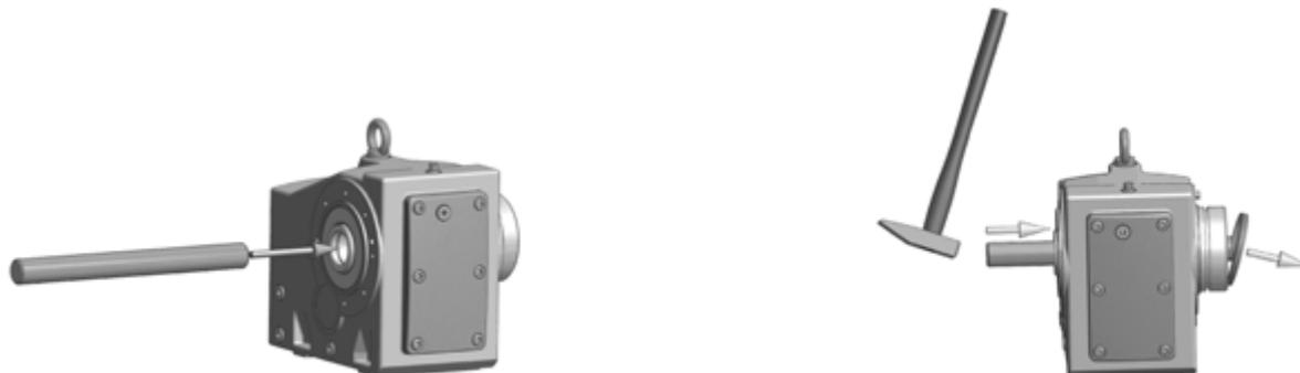
Figura 8: smontaggio del cappuccio montato in fabbrica
