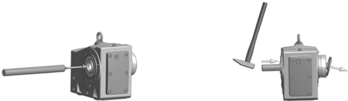
図 8: 工場出荷時に取り付けられたシーリングキャップの取外し
