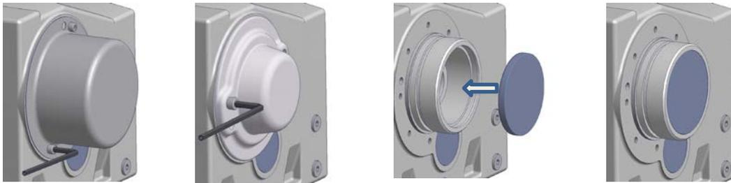
그림 17: 커버 옵션 SH, 옵션 H 및 옵션 H66 설치
