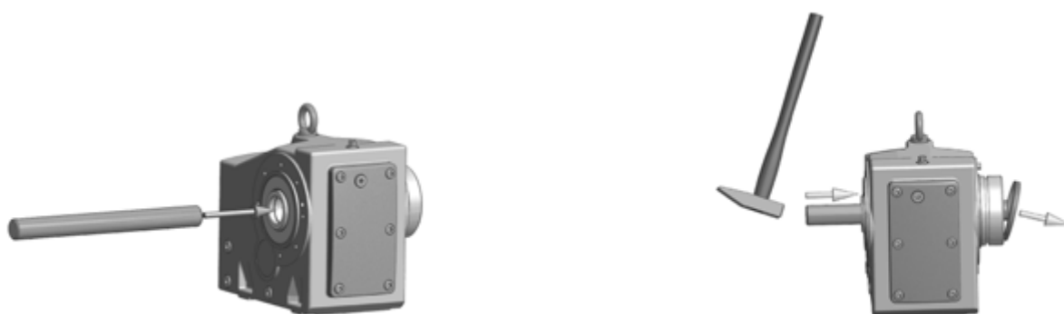
Илустрација 8: Демонтажа на фабрички монтираната заптивна капа
