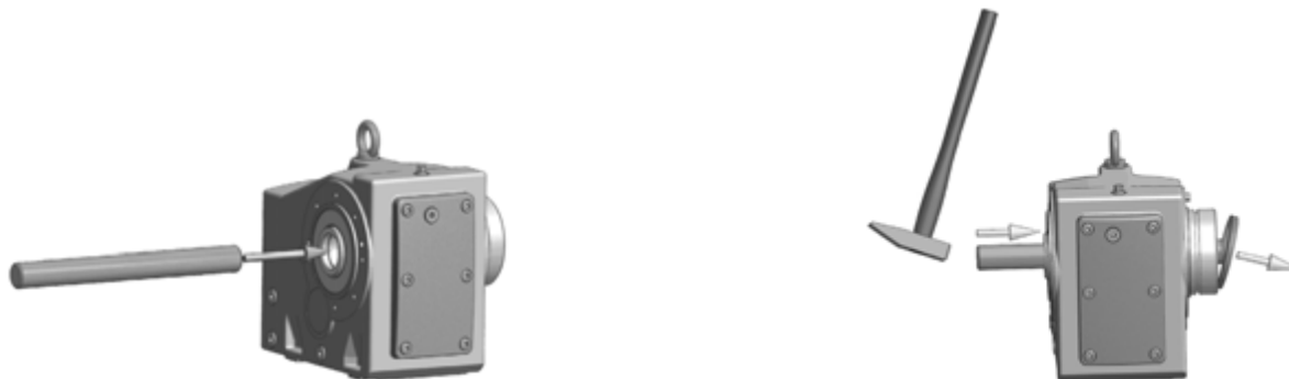
Afbeelding 8: Demontage van de af fabriek gemonteerde afsluitkap
