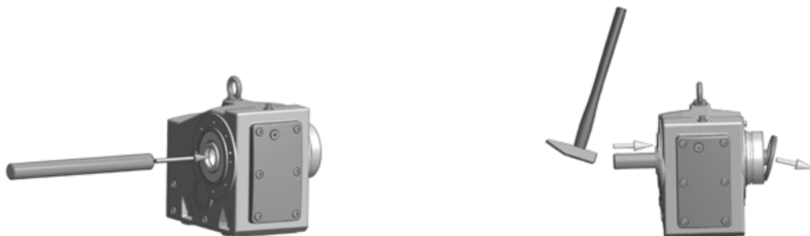
Fig. 8: Demontering av den fabrikkmonterte lukkeheten
