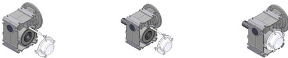
Fig. 18: Demontering og montering av dekselheten
