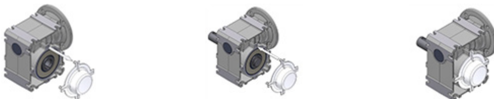
Rysunek 18: Demontaż i montaż pokrywy
