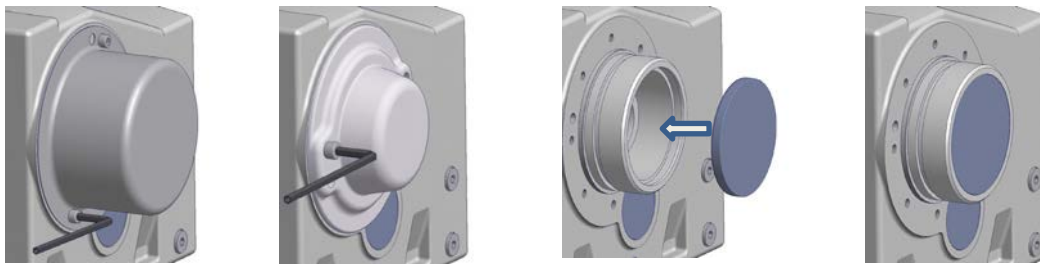
Rysunek 17: Montaż pokryw w opcjach SH, H i H66
