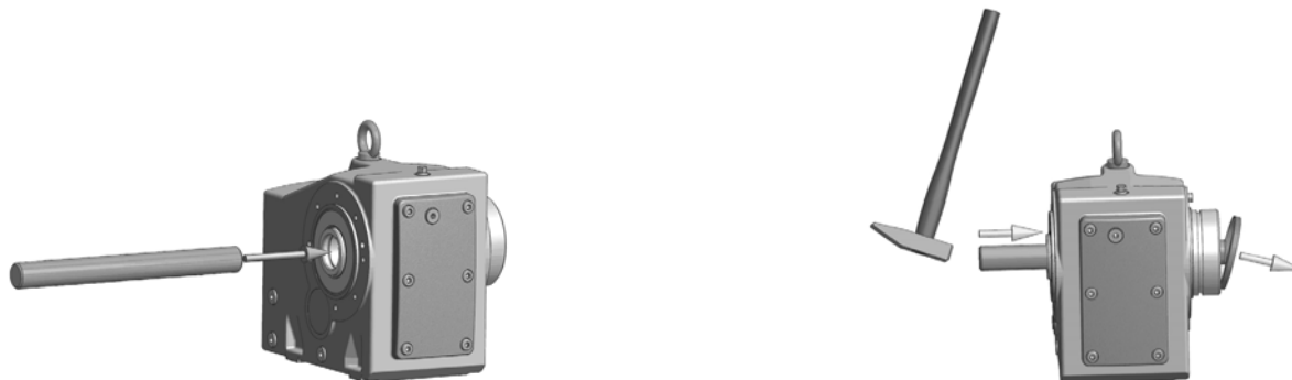
Rysunek 8: Demontaż fabrycznie zamontowanej pokrywy zamykającej
