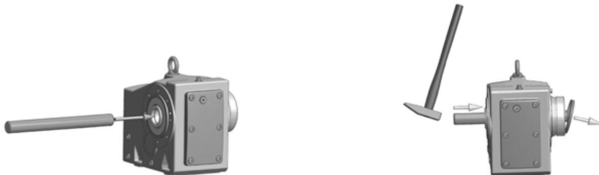
Figura 8: Desmontagem do tampão montado de fábrica
