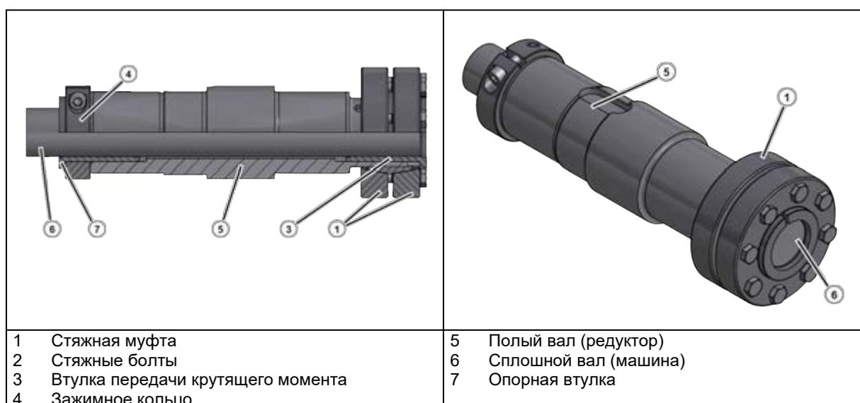
Рис. 15: GRIPMAXX™, в установленном виде
