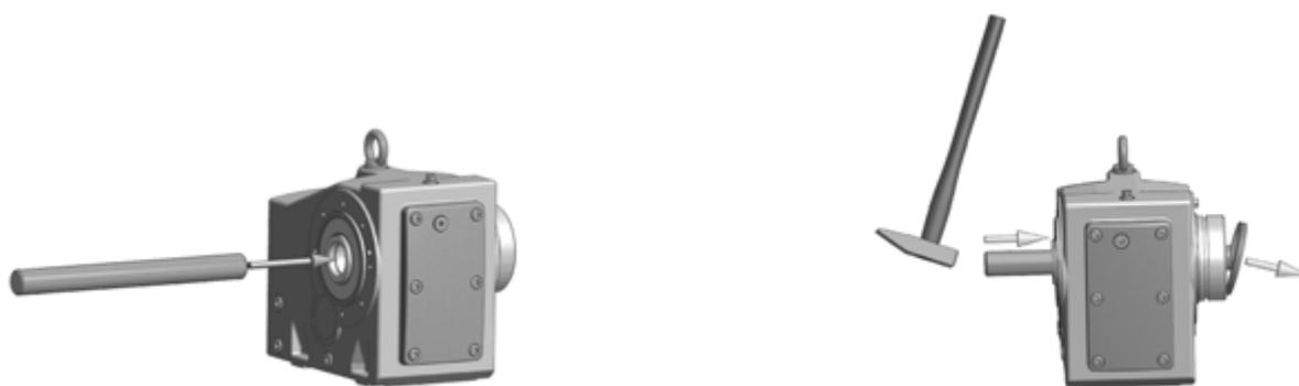
Рис. 8: Извлечение установленных на заводе заглушек
