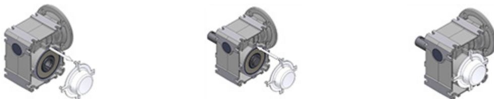
Slika 18: demontaža i montaža pokrivne kapice
