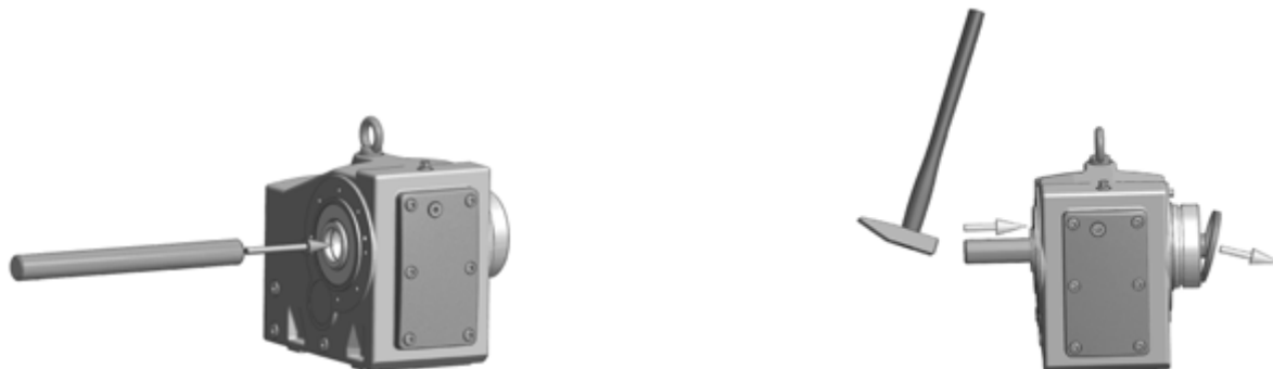
Slika 8: demontaža fabrički montirane kapice za zatvaranje
