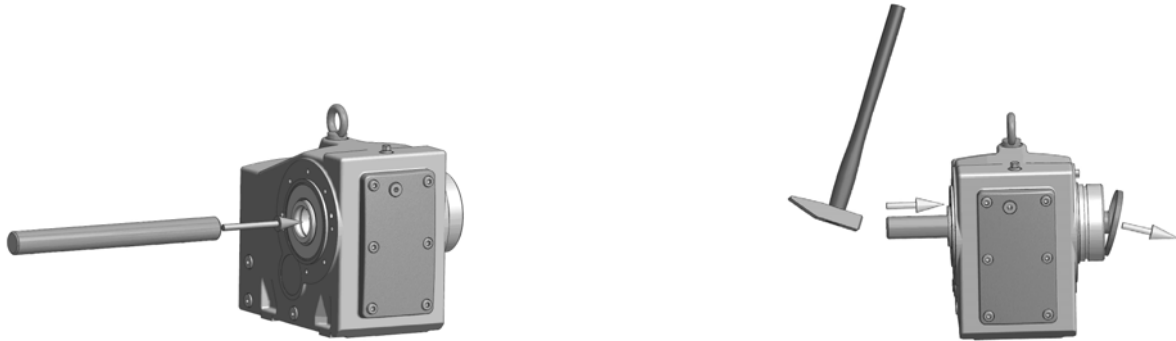
插图 7：拆卸制造商已安装的密封盖
