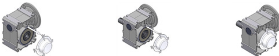
Abbildung 16: Demontage und Montage der Abdeckkappe
