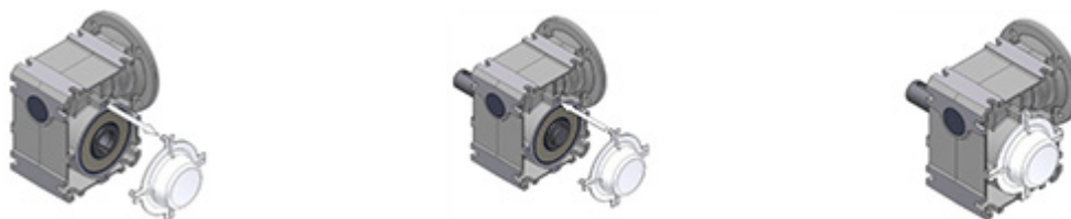
Εικόνα 16: Αποσυναρμολόγηση και συναρμολόγηση του καλύμματος
