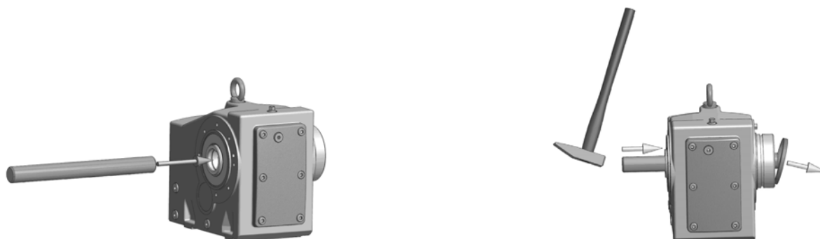
Εικόνα 7: Αποσυναρμολόγηση του καλύμματος ασφάλισης που έχει τοποθετηθεί από το εργοστάσιο
