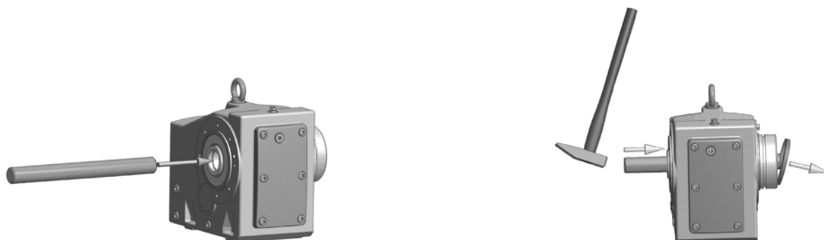
Figura 7: Desmontaje de la caperuza de cierre montada de fábrica
