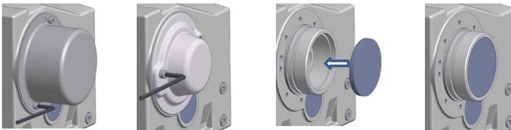
Figura 15: Montaje de la tapa de protección (opción SH, opción H y opción H66)
