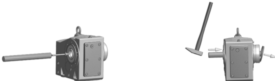
Kuva 7: Tehtaalla asennetun sulkutulpan irrottaminen
