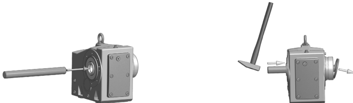
7. ábra: A gyárilag felszerelt zárófedél leszerelése
