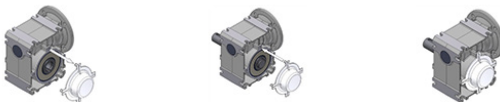
16. ábra: A zárókupak le- és felszerelése
