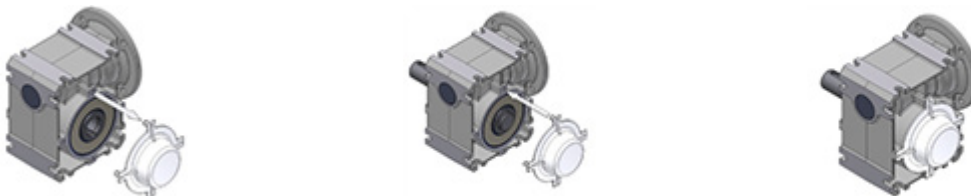
그림 16: 커버 캡 제거 및 조립 방법
