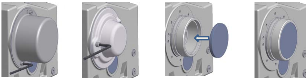
15 pav. Parinkčių SH, H ir H66 gaubtų montavimas
