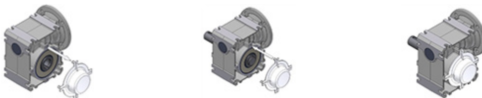
16 pav. Gaubtelio išmontavimas ir montavimas
