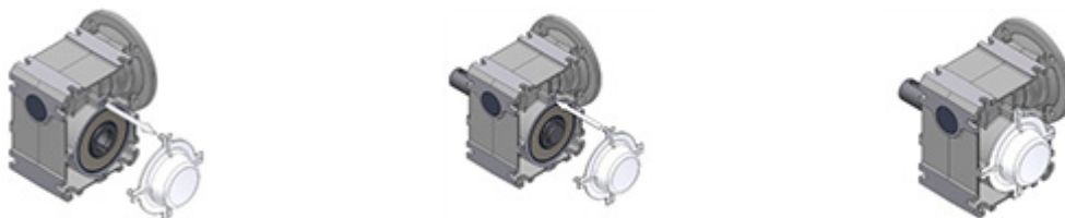
16. attēls: aizsargvāka demontāža un montāža
